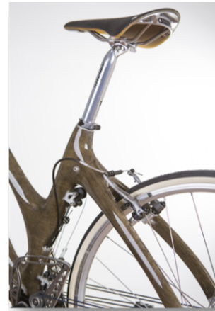
10. ábra Bio-kompozitból készült kerékpár váz (forrás: Meshlin (2015b))
