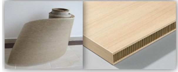
6. ábra Bio-kompozit prepreg tekercs és szendvics szerkezet (forrás: Meshlin (2015b))
